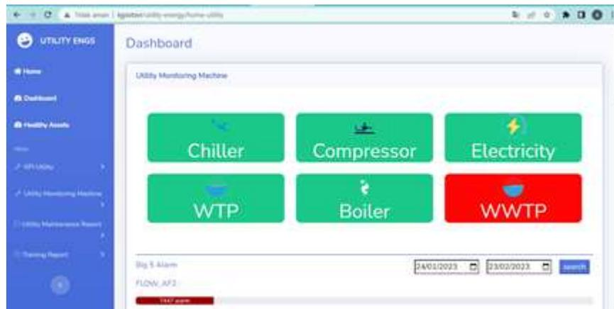
Berdasarkan diatas terdapat 6 section atau area yakni chiller, compressor, electricity, WTP (Water Treatment Plant), WWTP (Waste Water Treatment Plant) dan boiler yang datanya berasal dari data realtime mesin, kemudian section atau area tersebut akan berubah menjadi warna merah apabila nilai mesin melebihi batas atau standard yang telah ditentukan.
